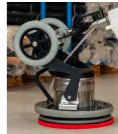
Kippbare Deichsel zur Erhöhung des Anpressdruckes.
